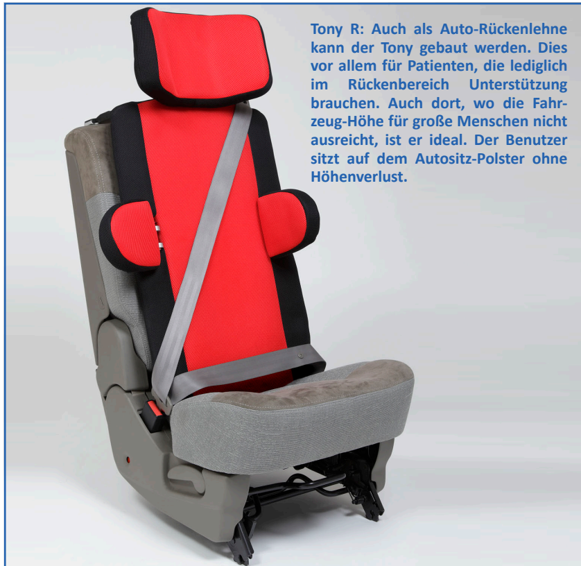
Lasche für den Fahrzeug-Dreipunktgurt; nur er hält beim Crash
