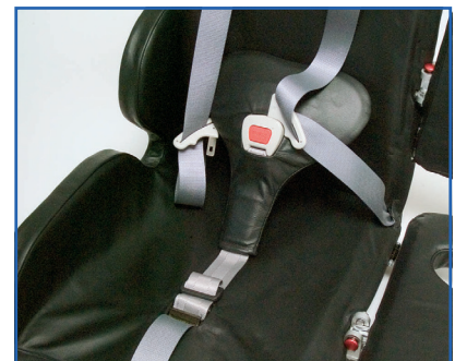
Ziehen: Gurt spannen, Knopf drücken: entspannen
